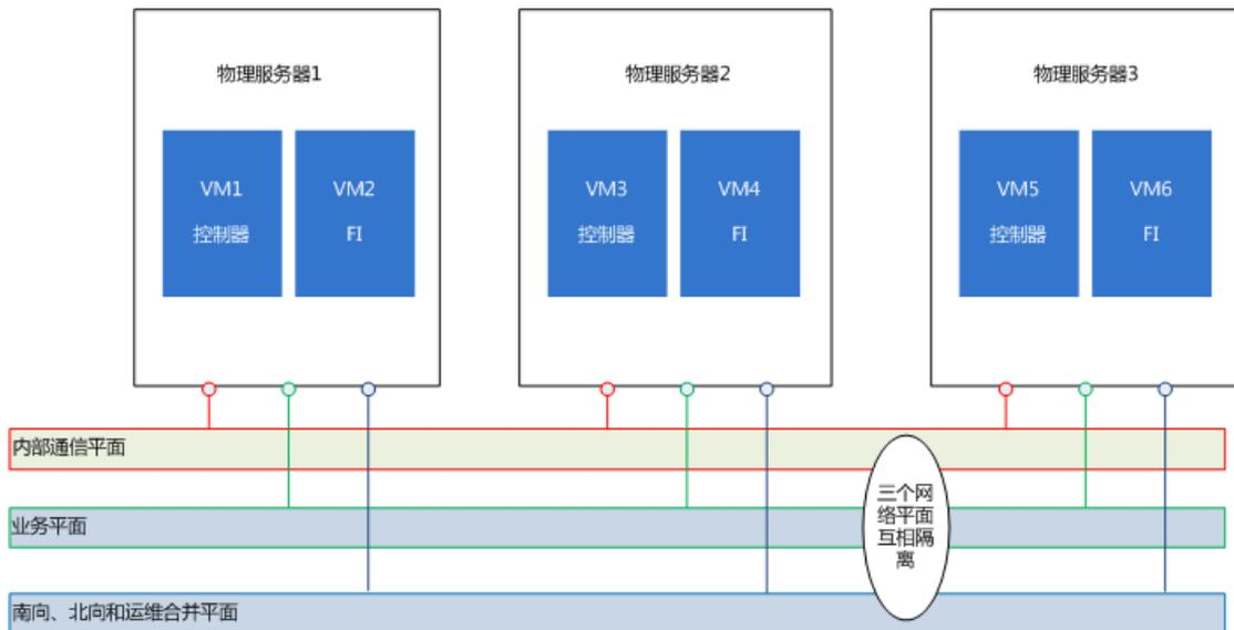
通过虚拟机部署 Agile Controller-Campus 集群时，典型部署场景为 Agile Controller-Campus 整体部署在三台物理服务器上。
