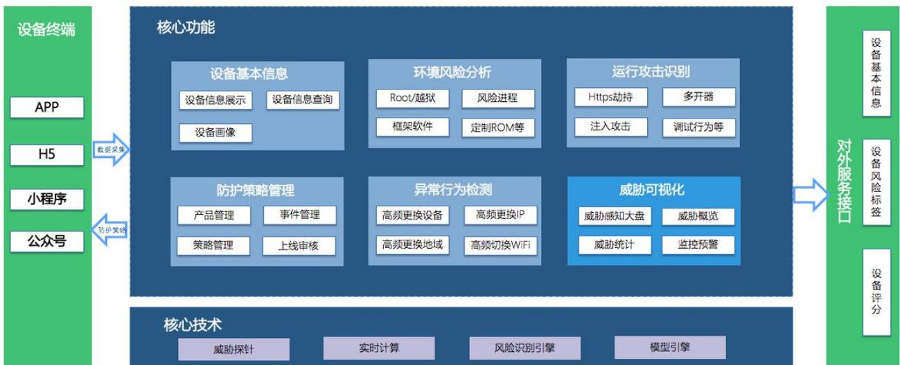
业务安全感知覆盖安卓和 iOS 原生态 APP、H5、微信小程序、微信公众号，原生态 APP 以 SDK 方式接入，H5、小程序、公众号通过 JS 文件集成。在后台管理界面可以查询环境相关、运行时相关的风险项。在指标特征模块可以配置行
