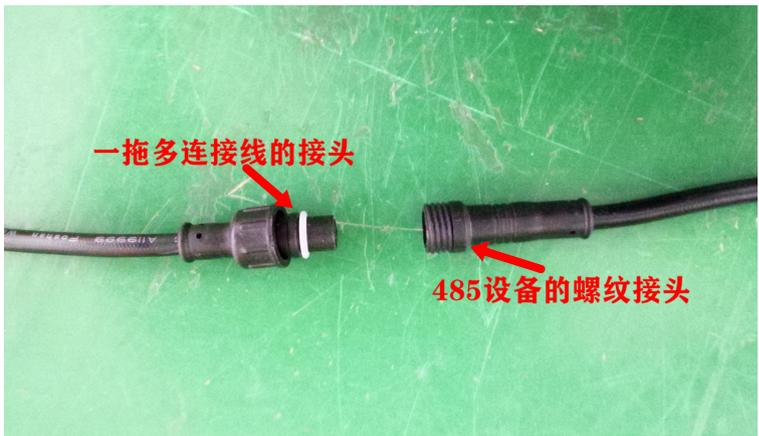
将 485 设备的螺纹接头接到对应的一拖多线上即可
