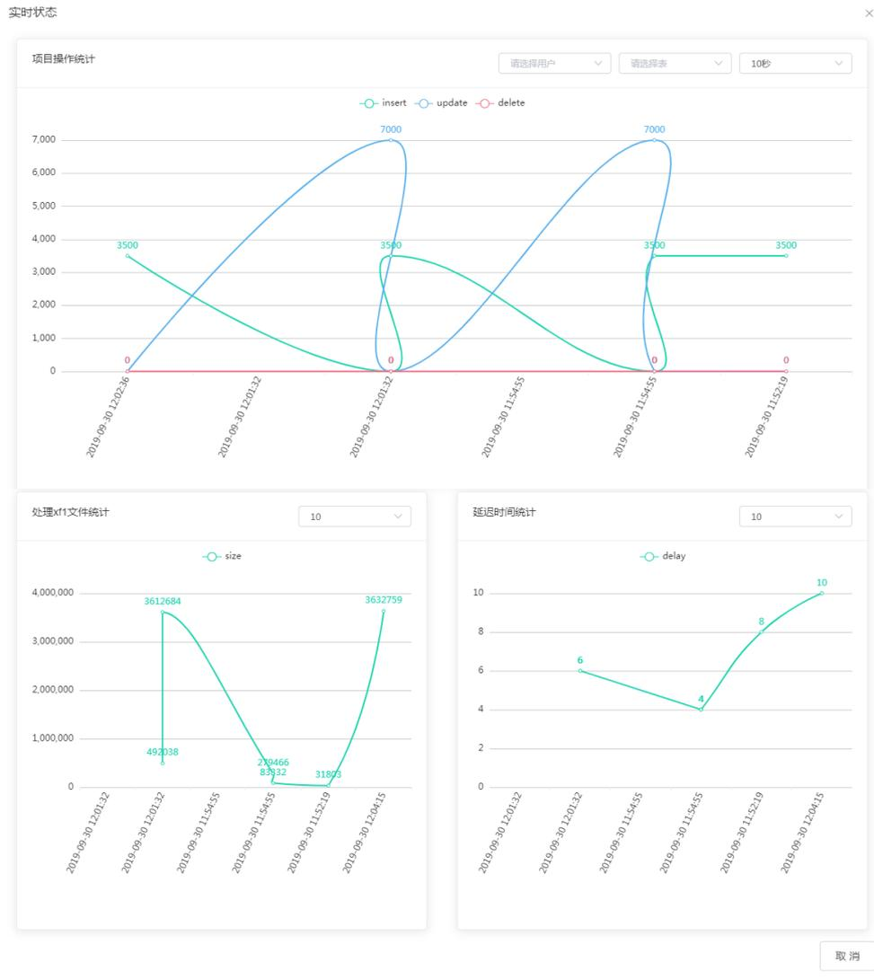
5、用户也可以单击“实时同步指标”，查看每个项目的数据增量同步实时统计信息，如图 65 所示。在上方的下拉框中选择需要查看的项目，下方将显示该项目的实时统计信息，包括实时 dml 执行数量统计、处理的 xf1 文件个数统计及同步延迟时间统计。
