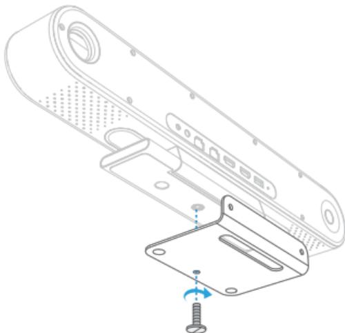
② 用挂墙支架套装自带的固定螺钉，穿过支架预留孔，旋入主机底座固定孔
