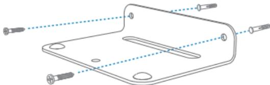
① 按照支架孔距在墙上打孔，旋紧螺钉到膨胀管中，将挂墙支架固定到墙上
