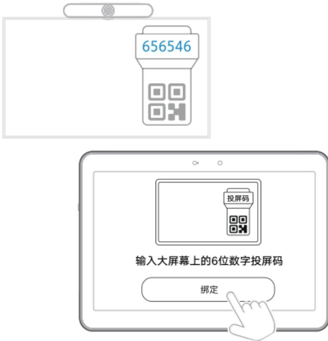
\*主机屏幕显示5位投屏码时，请检查主机网络连接是否正常和稳定
