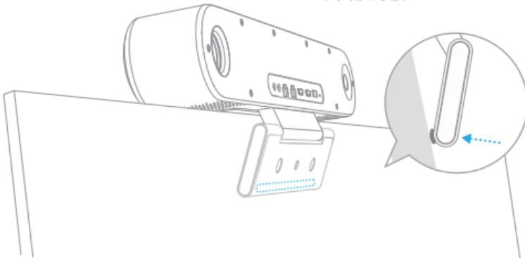
③ 调整主机底座，配合透明固定卡扣夹紧电视机，调整底座使双面胶粘紧电视机背面，固定主机
