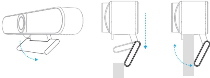
① 旋转主机可调节底座，用前部透明固定卡扣挂住平板电视，再旋转底座稳定支撑
