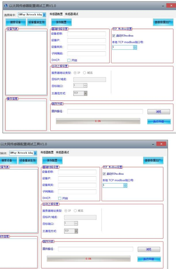
软件界面分为如下几部分，如图，左边为设备搜索和操作信息显示区域，中间为配置区域，可以进行设备的基本配置，传感器的调试与固件升级。
