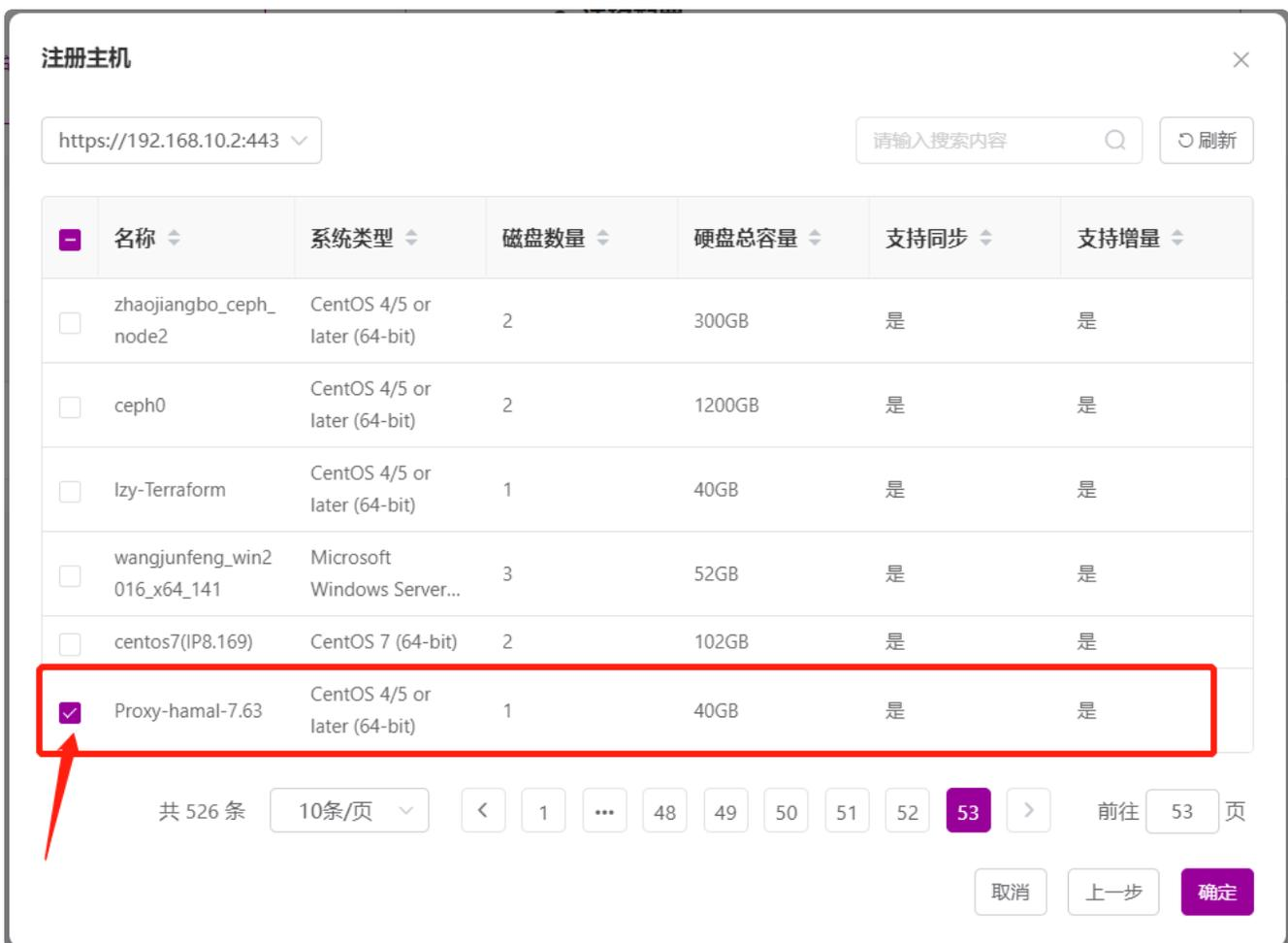
之后，在迁移界面可以看到 待迁移的VMware主机清单，勾选要操作的主机，点击下一步，开始进行迁移配置了，
