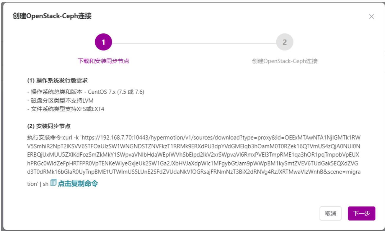
第四步：在openstack源端创建的proxy主机上，执行上一步复制的命令，结果如下：
