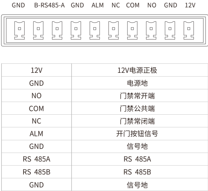
图 3-1-4 10PIN 绿色端子接线图
