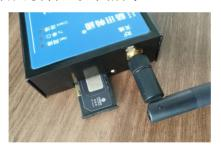
将传感器黄蓝线对应接到云盒接口 485A 和485B,使用 12V 电源给贯桥云盒供电。上电后发现红色灯以 100ms 亮/700ms 灭的频率闪烁,此时设备正在尝试接入 4G 网络,等待几十秒左右,设备会成功的接入 4G 网络,此时红灯以 100ms 亮/1900ms 灭的频率闪烁。
