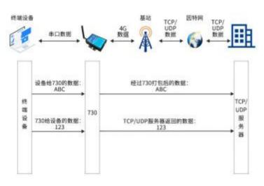
贯桥云盒可以实现 4G 网络接口与串行接口的无缝转换,贯桥云盒在工作室进入透传模式,在透传模式下串口数据和服务器的数据经过贯桥云盒打包后会传到另一方。设备只要在使用前做简单设置即可长期工作在透传模式下。
