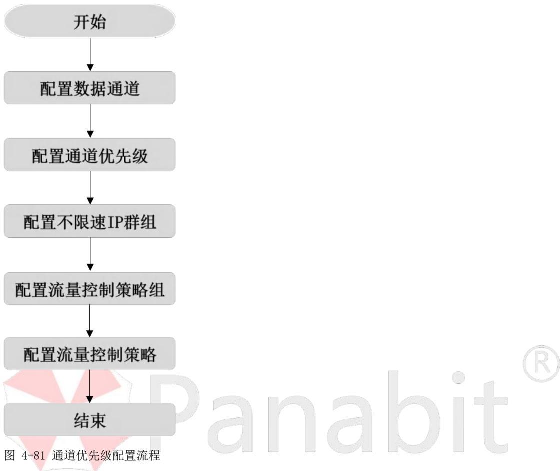
图 4-81 通道优先级配置流程
