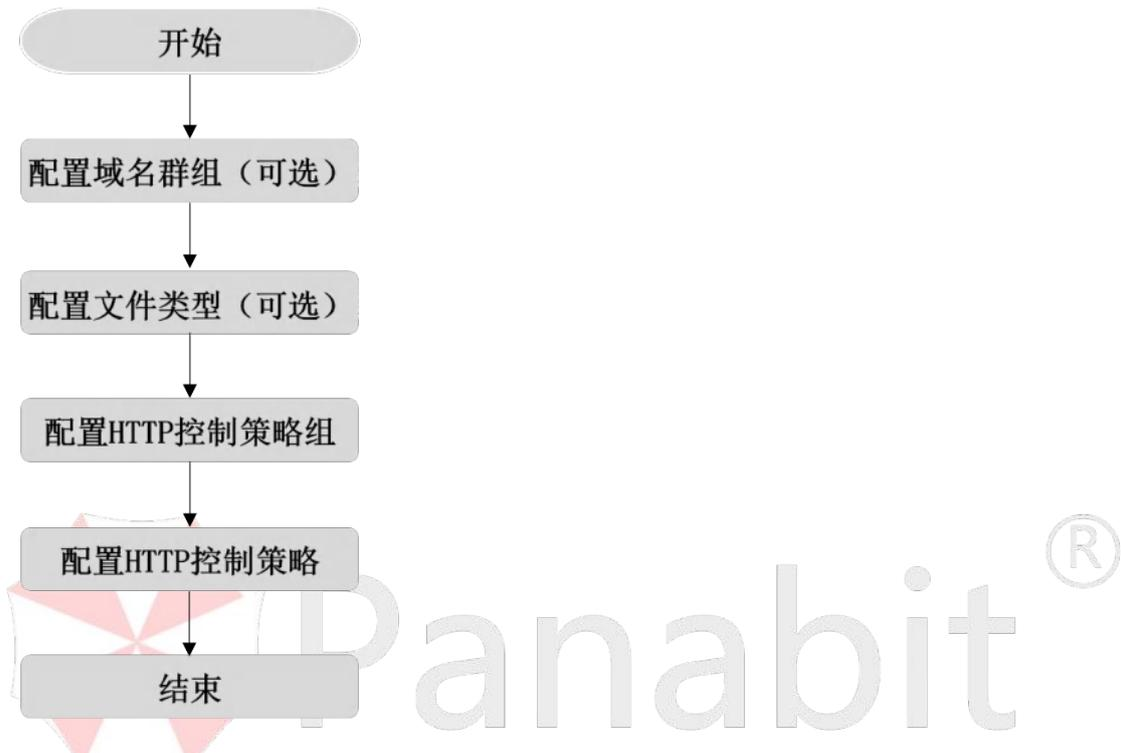
图 4-83 HTTP 管控配置流程
