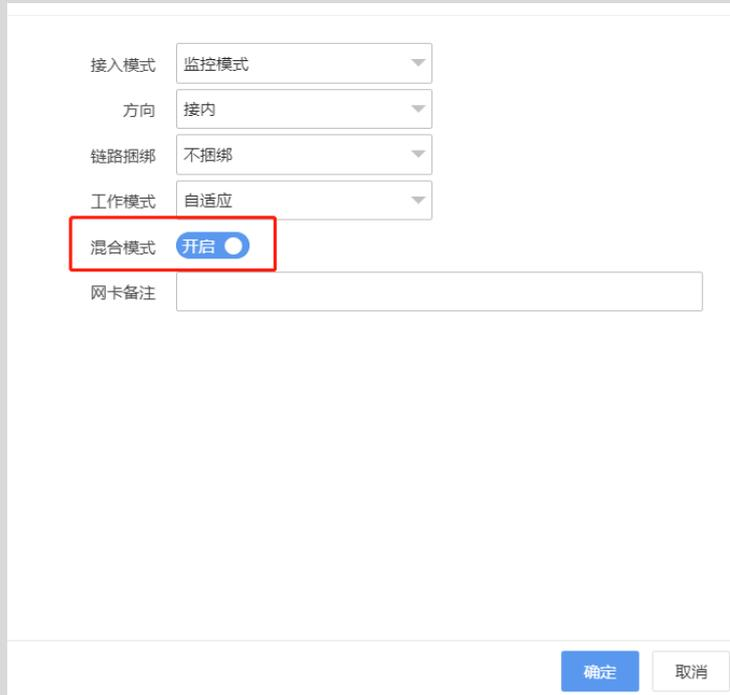
在没有设置【伪 IP 防护】的情况下，开启网卡混合模式后，系统根据会话的源地址和目的地址流量来决定上下行，源->目方向为上行，目->源方向为下行，并且以会话的源地址创建内网在线用户（TCP 会话根据三次握手确定源地址，UDP 会话根据首包确定源地址）。
