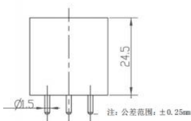
图 1: 模组结构图(顶视和侧视图)
