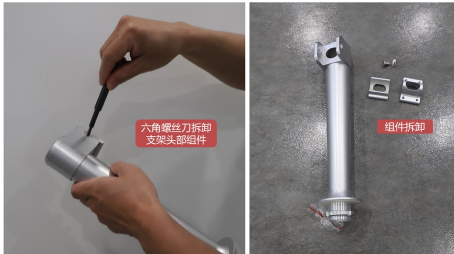
图 3-1-4 闸机支架部件拆卸
