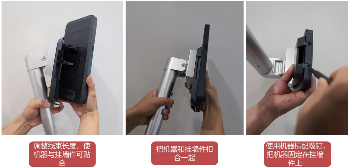
图 3-1-8 固定好机器和挂墙件
