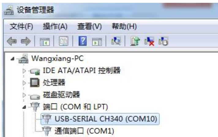
如上图所示，此时您的串口号为 COM10，请记住这个串口，需要在变频器监控软件中填入这个串口号。
