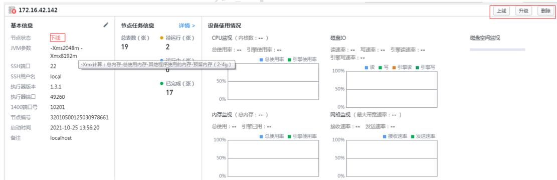
(2) 节点在上线状态支持下线和重启操作, 该节点如果有任务正在运行需等待任务运行完成或者手工停止所有正在运行的任务方可将该节点下线或者重启。
