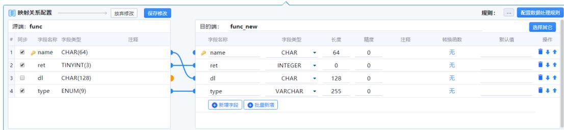
对于需要对字段内容进行处理转换的场景，工具支持指定字段使用函数进行字段转换，包括日期格式转换，字符串替换、分割，下载 url 指向的 web 资源等。点击目的数据集字段列表“转换函数”字段标题下的单元格即可弹出函数转换窗口。
