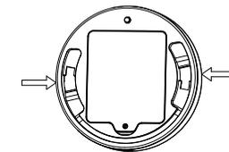
第五步: 安装设备, 设备背面缺口位置对准支架凸点
