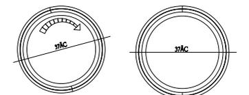
第六步: 设备放到支架的对应位置后, 沿箭头指示方向旋转固定设备
