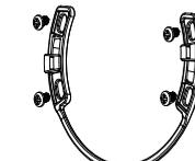
第四步: 用4个M3的螺丝把支架固定到墙壁上
