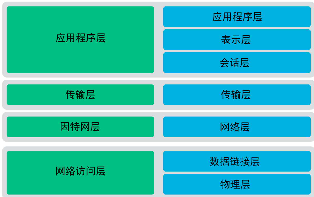
图 17.1 : TCP/IP 的简化层次模型
