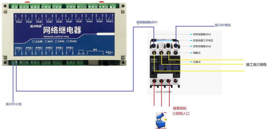
上图是 16 通道网络继电器控制雾炮的连线图示。
