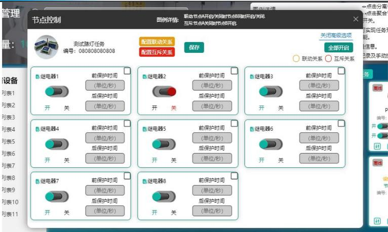
如图示在继电器开关的右边可以设置保护时间，即是开启延时和关闭延时，此处只要设置好保护时间再开启继电器就会自动开启延时。
