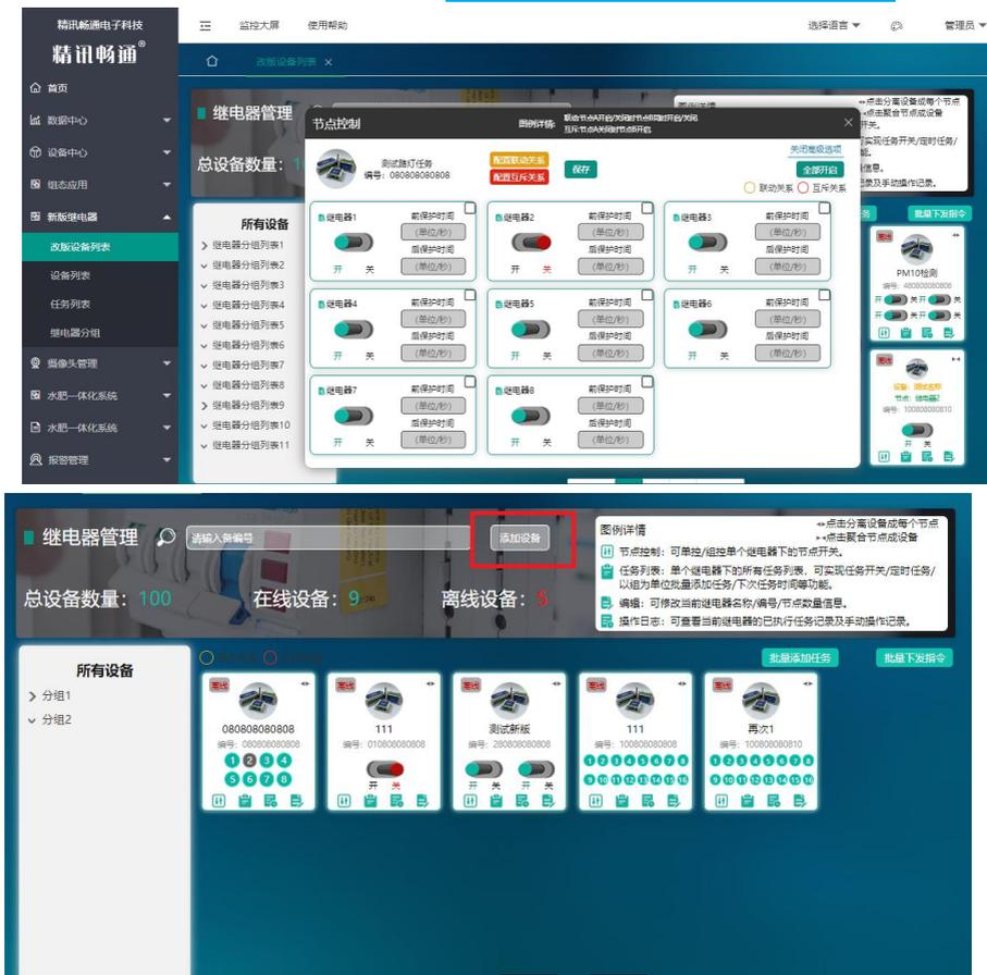
如上图所示，进入继电器管理页面后可查看当前添加的继电器状态，点击第二张图红框中“添加设备”可以根据设备号将设备添加到继电器管理。页面如下图所示
