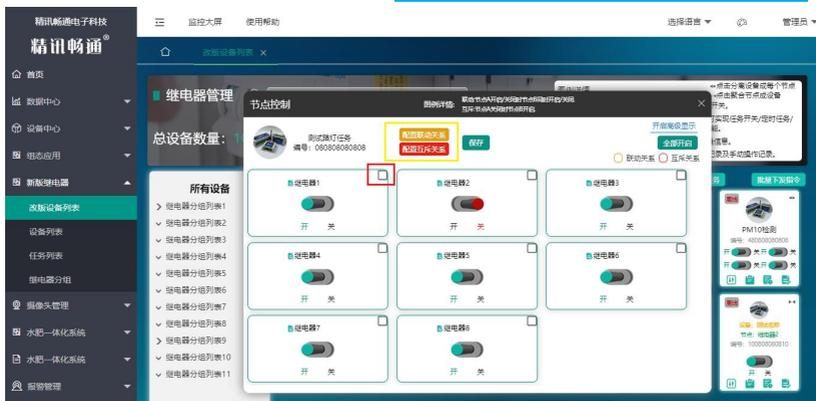
上图为继电器即时控制与设置页面，点击对应继电器的开关可以对继电器状态进行即时控制，点击右上角“全部开启”即开启全部继电器，再次点击全部关闭；图中点击勾选红圈中的方框，选中任意两个或多个后即可点击黄框中的第一项-配置联动关系，选中任意两个后即可点击黄框中第二项-配置互斥关系，配置好之后可选择右上角的联动关系或互斥关系，来决定下发的即时控制指令中是否需要联动或互斥；右上角“开启高级显示”，点击后出现如下界面
