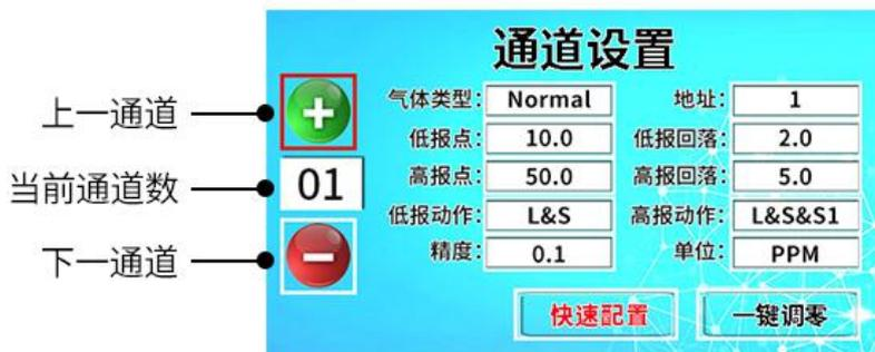
报警动作包括四部分，指示灯指示、声光报警、继电器 1 动作、继电器 2 动作，其中指示灯指示是固定存在的方式，其余三种可以自行选择，具体参加下文表格。
