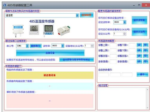
打开软件后，首先选择软件顶端“传感器类型”，再根据 3.1 章节的方法获取到串口号并选择正确的串口，然后单击“自动获取当前波特率和地址”即可自动探测到当前 485 总线上的所有设备和波特率。请注意，使用软件自动获取时需要保证 485 总线上只有一个传感器。然后单击“连接设备”后即可实时获取传感器数据信息。
