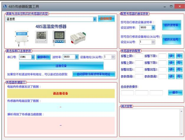
打开软件后，首先选择软件顶端“传感器类型”，再根据 3.1.1 章节的方法获取到串口号并选择正确的串口，然后单击“自动获取当前波特率和地址”即可自动探测到当前 485 总线上的所有设备和波特率。请注意，使用软件自动获取时需要保证 485 总线上只有一个传感器。然后单击“连接设备”后即可实时获取传感器数据信息。
