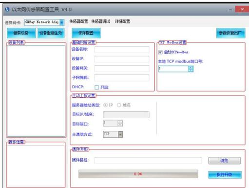
软件界面分为如下几部分，如图，左边为设备搜索和操作信息显示区域，中间为配置区域，可以进行设备的基本配置，传感器的调试与固件升级。
