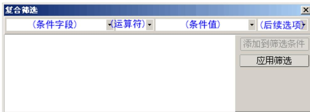
在该窗口可以通过四个下拉列表框来构建筛选条件，条件字段下拉列表、运算符下拉列表和条件值下拉列表可上面的单步累积查询功能相同，后续选项用来确定是否还有后续条件设置。每步条件设置完毕后通过单击“添加到筛选条件”按钮添加到筛选条件区域。多步条件设置完毕后通过“应用筛选”按钮完成本次筛选，系统会对表格界面当前的数据源（主表）进行筛选，然后显示筛选后的数据。
